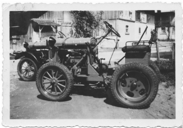
Vor dem Umbau 1939 wies dieser Bührer-Traktor (im Vordergrund) eine vertikal angeordnete Lenksäule auf. Er gehörte der Familie Blättler im Gigi. Bildaufnahme: vor der Umbauwerkstatt.
